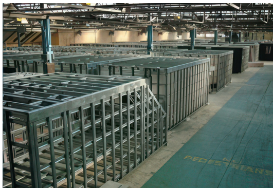
3; 3.1-сурет: Жеңіл болат қаңқасын пайдалану мен модульдік құрылыс (фото ayrshire framing компаниясының рұқсатымен) Дереккөз: https://www.specifiedby.com/ayrshire-metal-products
