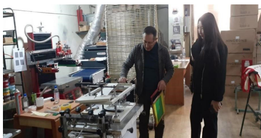
Сурет 13. Бояу құтыларының сыртына шелкография техникасы арқылы сурет басып шығаратын станокті көрсету барысы (SAMAD Group, 2025).
