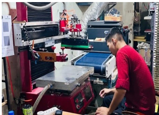
Сурет 5. Шелкография техникасы арқылы басу процесі (SAMAD Group, 2025)
