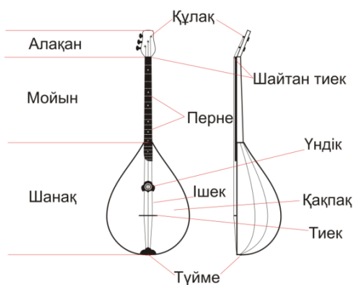
5-ші сурет. Домбыра пикколоның құрылысы және бөлшектерінің атаулары.
